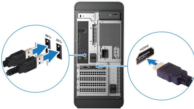
**ANMERKUNG:** Verbinden Sie das Headset mit dem HDMI-Anschluss an der diskreten Grafikkarte und den Bildschirm mit einem der verfügbaren Anschlüsse an der Karte.
